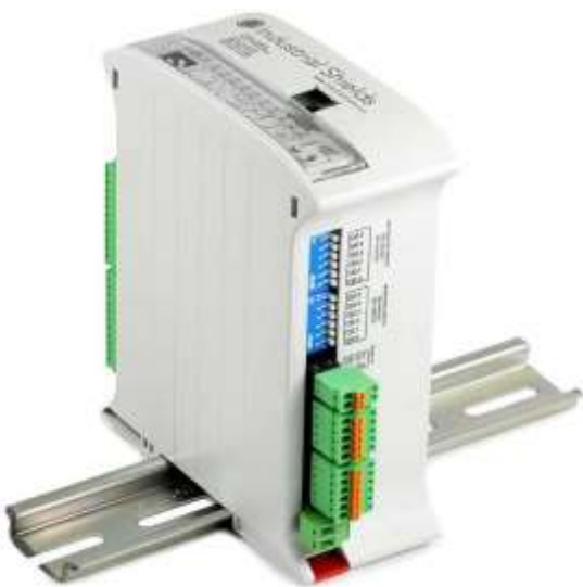
l Esempio di PLC realizzato con tecnologia ARDUINO
