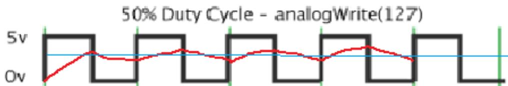
Figura 4 Onda quadra e circuito RC. La linea rossa rappresenta la carica e la scarica del condensatore, la linea azzurra rappresenta il valore medio di tensione in uscita
