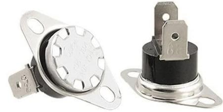
termostato è costituito da due metalli termicamente diversi saldati l'uno all'altro. Quando fa freddo i contatti sono chiusi e la corrente passa attraverso il termostato. Quando diventa caldo, un metallo si espande più dell'altro e la striscia bimetallica incollata si piega verso l'alto (o verso il basso) aprendo i contatti impedendo il flusso di corrente.
