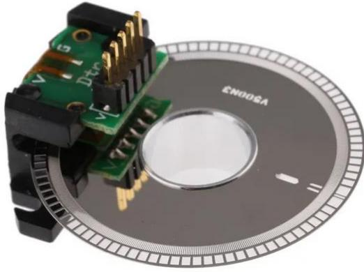
Figura 4 Dispositivo encoder incrementale-fotocellula
