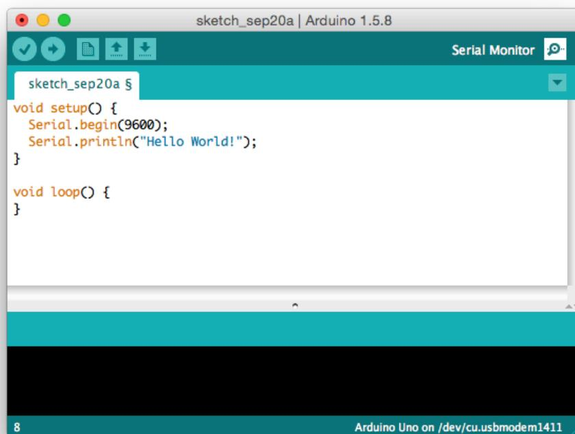
Fig. 5.18 – Per aprire il Serial Monitor premete il pulsante sulla toolbar di Arduino.
