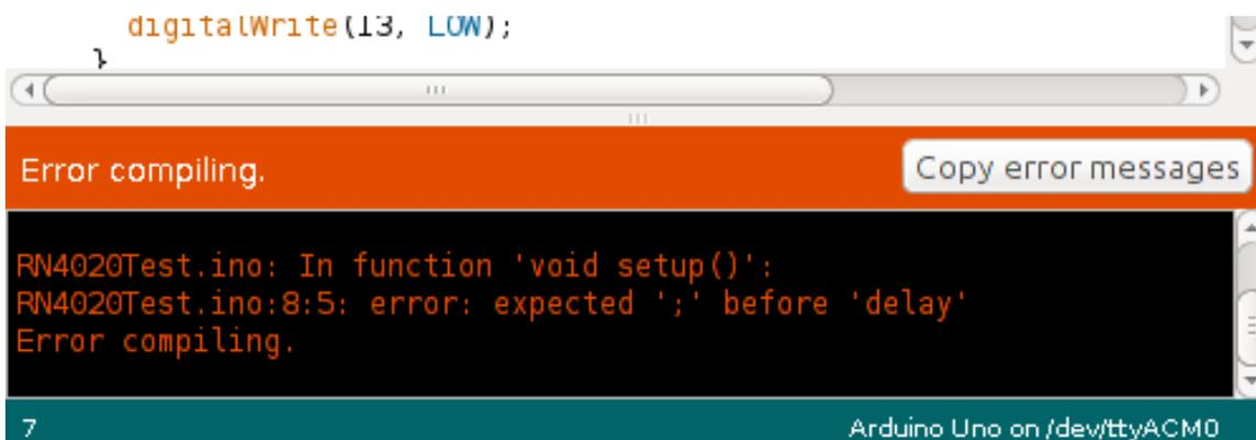
Fig 5.4 – Messaggi di errore nell'area inferiore della finestra di Arduino: è stato rilevato un errore alla linea 8, colonna 5 dello sketch.
