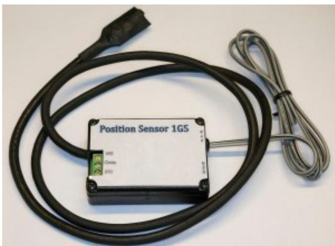
Il trasduttore, da porre sulla parte meccanica in movimento, è collegato al circuito tramite un cavo di prolunga mentre il resto dell'elettronica dovrà essere inscatolata in un contenitore in ABS di piccole dimensioni. Il sistema, collegato al PC tramite porta USB, può essere programmato per assegnare i tempi e la sensibilità d'intervento del relè.
