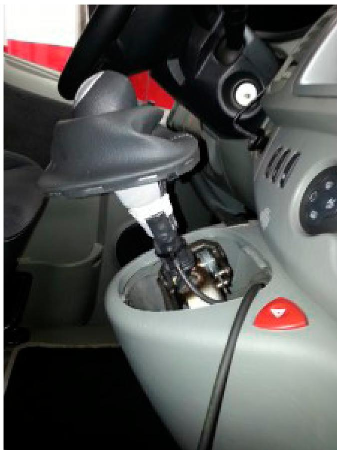
Il secondo passo consiste nel collegare i contatti del relè al carico, quest'operazione può essere svolta in due modi. Il primo consiste nel collegare i contatti del relè in serie al fusibile del climatizzatore, tagliando il filo corrispondente dietro alla scatola fusibile. Per questa scelta bisogna settare il relè in **modalità “Sw”**. Il secondo metodo è quello di collegare i contattati del relè **in parallelo al pulsante “AC”** del clima per simu-
