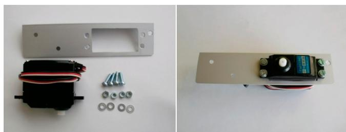
Il montaggio incomincia con le traverse laterali **[2]**, i due servomotori a rotazione continua **[5]** ognuno mediante n°4 viti M3x8 **[16]**, n°4 dadi M3 **[15]** e n°4 rondelle piane  $\varnothing 3,2$  **[19]**.
