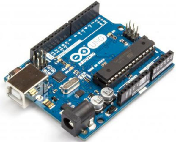
Figura 1.3.1: Sistema di controllo, Arduino UNO.
