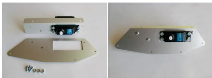
Si fisserà quindi al telaio laterale completo di servomotore la piastra di alluminio laterale **[1]** utilizzando 3 viti lunghe M3x10 **[19]** e 4 dadi M3 **[15]**.
