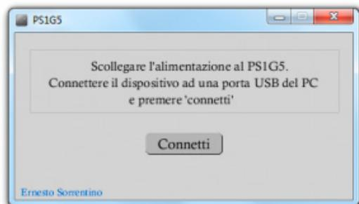
Cliccando sul pulsante **“Connetti”** il programma tenterà una connessione con Arduino e dopo aver stabilito il collegamento cambierà videata passando a, **quella nominata nello sketch, “window 2”**.
