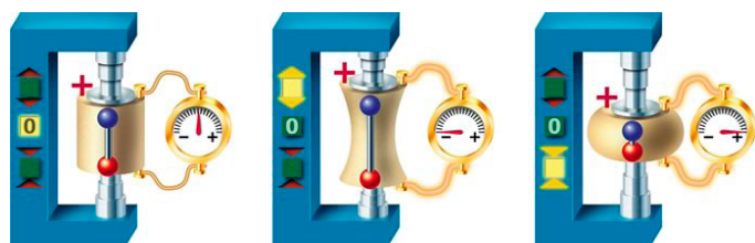
Figura 3: Schema di funzionamento di un cristallo piezoelettrico.
