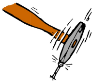
Fig.36 Possiamo paragonare la potenza ad un "martello". Un piccolo martello ha una potenza minore di un martello di dimensioni maggiori. Per questo motivo una lampada da 10 Watt eroga meno luce di una lampada da 100 Watt ed un motore elettrico da 1.000 Watt eroga più potenza rispetto ad un motore da 500 Watt. Maggiori sono i Watt della lampada, del motore o del circuito che alimentiamo, più Amper sono assorbiti dalla sorgente.
