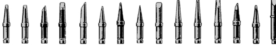
Fig.145 Tutti i saldatori professionali, cioè quelli più costosi, sono dotati di una serie di punte intercambiabili che possono avere forme diverse. Le punte sottili vengono adoperate per stagnare terminali molto ravvicinati, le punte medie per normali stagnature e le punte più larghe per stagnare superfici che potrebbero raffreddare una punta sottile.
